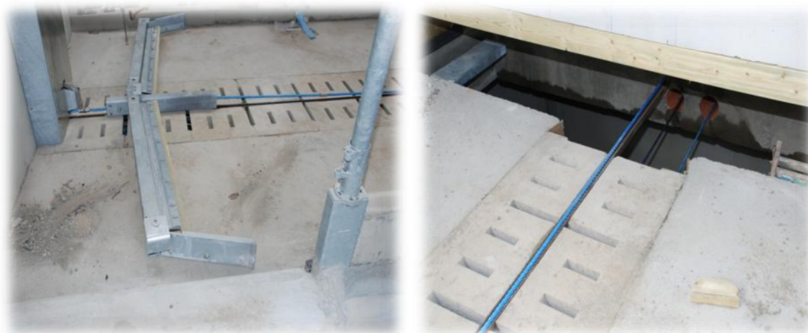
Figur 1. Vinkling af skraber for hurtig aflevering Figur 2. Aflevering for enden af staldgang
