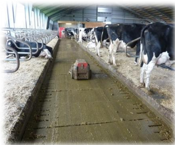
Figur 3. Rengøring med skraberobot
